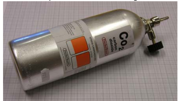
Gassflaske med ventil til påfylling av karbondioksid i den ene beholderen til 28205
